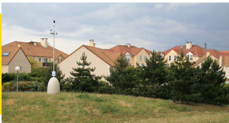
Une station de mesure du bruit intégrée à un mobilier urbain de type « Sonopode » pour la surveillance du bruit lié au trafic aérien à Conflans-Sainte-Honorine (Yvelines)
